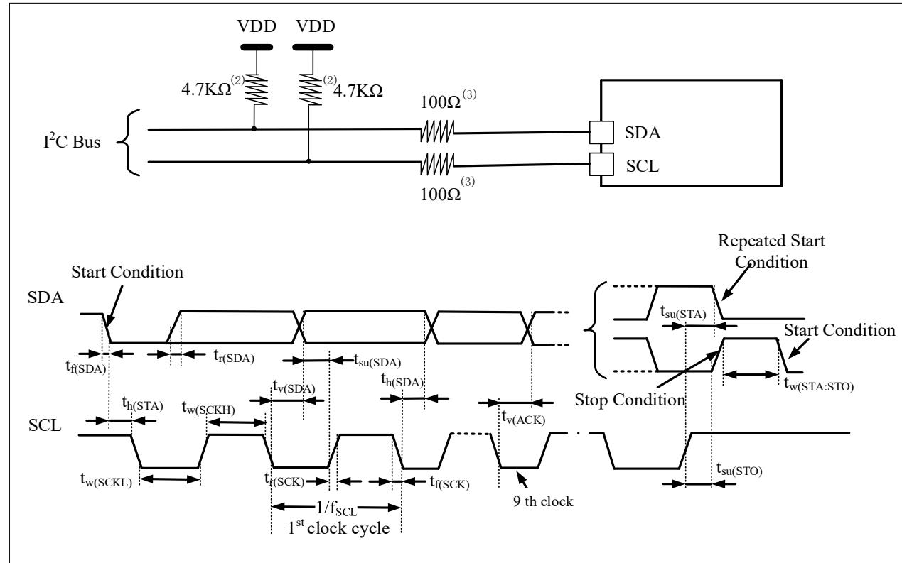
1. 测量点设置于CMOS电平: 0.3V<sub>DD</sub>和0.7V<sub>DD</sub>。
