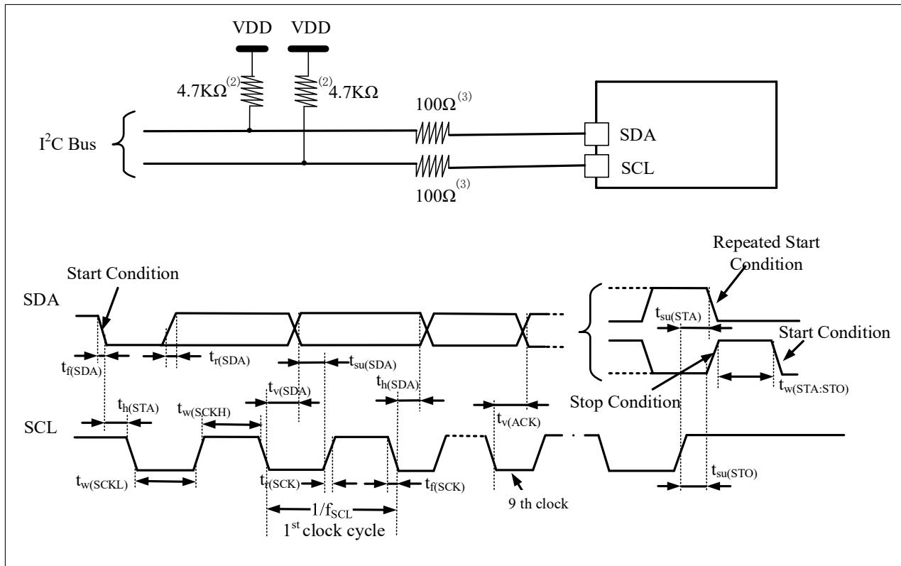
1. 测量点设置于CMOS电平：0.3V<sub>DD</sub>和0.7V<sub>DD</sub>。
